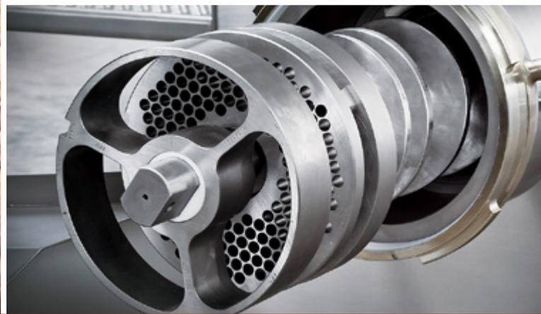
Zubringerschnecke aus Spezialguss mit Schälkante
