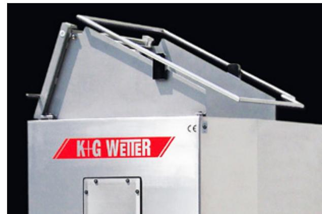
Elektrische Absicherung durch umlaufenden Rahmen mit Kontaktschaltern
