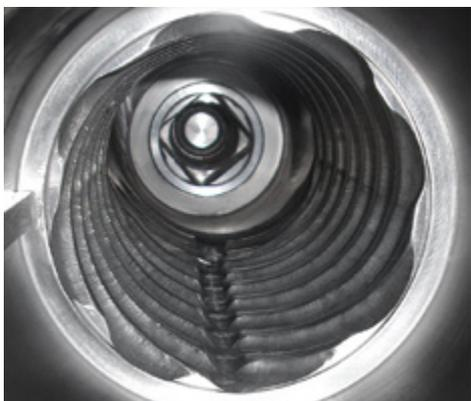
Massives, rostfreies Schneckengehäuse, robuste Lagerung des Antriebs
